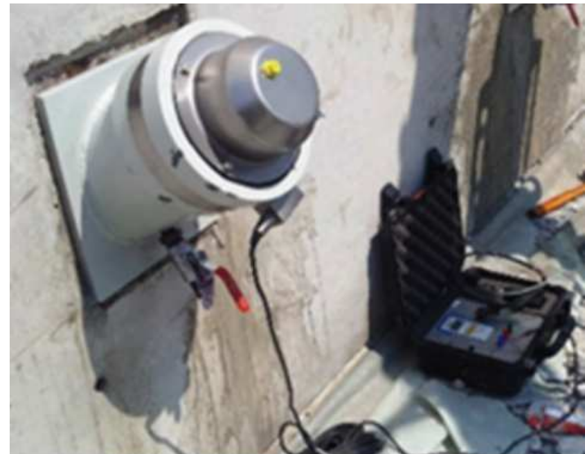
Photo 8.8 : Tête d'ancrage instrumentée avec protection de type P (© Soletanche Bachy)
